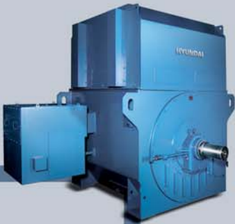
Высоковольтный асинхронный двигатель • 150 – 25,000лс • до 14кВ, 50/60Гц • 2-30-х полюсный
